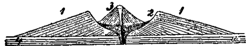
Переріз вулькану: 1. Первісний вулькан; 2. Зціпеніла лява; 3. Новий стіжок, з кратером; 4. Верстовані скали.
