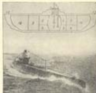
Підводне судно. Згорі перекрій, 1. центральна, 2. нева команданта, 3. вхід до нутра, 4. перископи, 5-7. мачта, 8. акумулатори, 9. мотори, 10 і 11. призначені на торпеди, 12. задня частина судна, 13. передня частина. Вдолі: Підводне судно „К-Х“ (Голландія).
