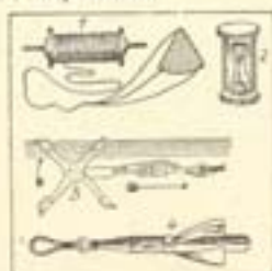
Льогі: 1. звичайний л., 2. льоговий годинник, 3. електр. л., 4. патентний л. Число оборотів, яке відчитується на шиферблаті, показує швидкість корабля.
