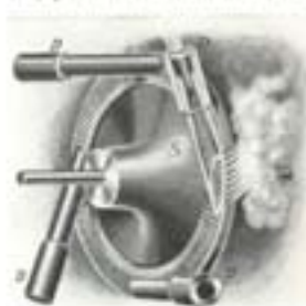
5. Парова турбіна (парні): В рухома шина, D парний дутин.
