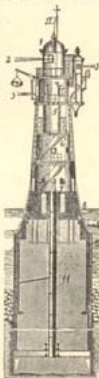
Маяк [перекрій]: 1. лямпа, 2. блимаче світла, 3. постійне світло, 4. помешання, 5. кула, 6. магазин, 7. лямпа, 8. рівень води в часті бурі, 9. середній рівень, 10. низький рівень, 11. спідня частина.
