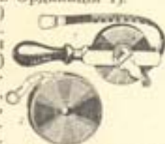
Рулетка мірича: 1. ручна стільва, 2. вишнена полотняна.
