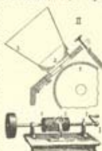
Фонограф Едісона: 1. валок покритий воском, 2. мембрана, 3. ворба, II. 1. валок, 2. мембрана з рильцем, 3. труба.
