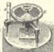
Сферометр: С 1 С 2 — ніжки, Е — кружкові мірлово, А — плітка, яку міряємо, В — мірло для повних оборотів, F В — шруба.
