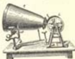
Фонавтограф: 1. труба з мембраною і рильцем, що записує на валку (2) криву тремтіння стросних вилок або сопілок.
